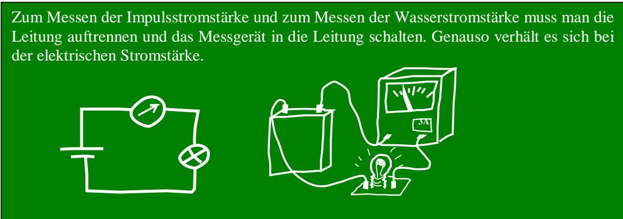
Abb. 12: Messung der elektrischen Stromstärke
