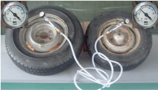
Abb. 1: Pneumatisches Gleichgewicht
