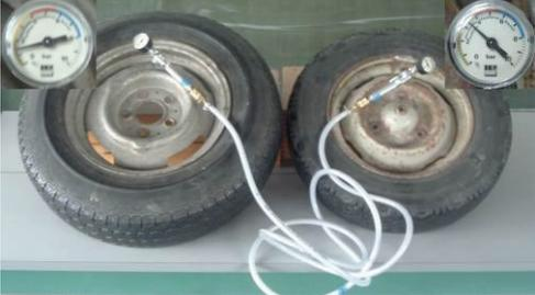
Die beiden Reifen sind durch einen Schlauch verbunden, die Ventile sind noch geschlossen. Das linke Manometer zeigt 1,5 bar und das rechte Manometer zeigt 3,5 bar.
