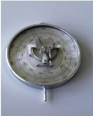
Abb. 3: Barometer
