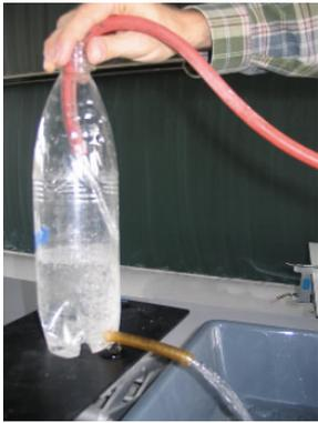
Abb. 5: Fließgleichgewicht bei Wasserströmen
